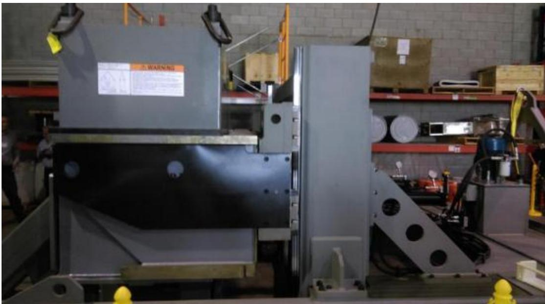
圖 31：遙控操作深層地質之 UFC 移動設備
