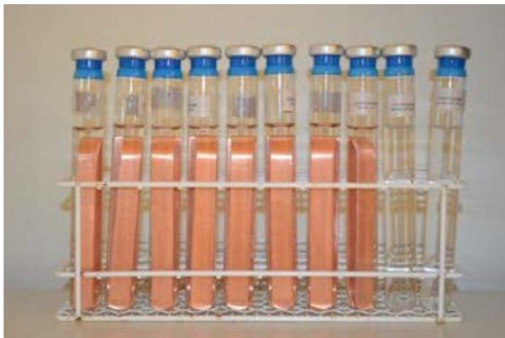
圖 18：Microbial Analytics 公司將各式銅試片浸於無氧純水之實驗方法
