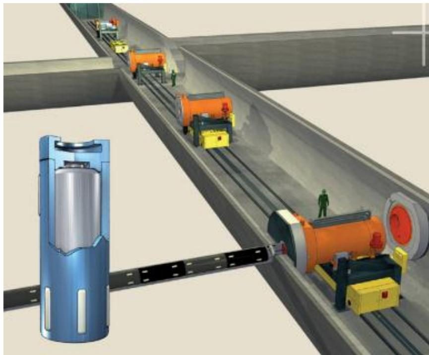
圖 10：微隧道(microtunnel)概念。
