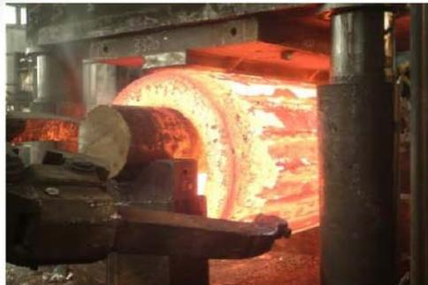
圖 8：廢棄物容器鍛鑄過程與 UC-V 容器尺寸對比示意圖。
