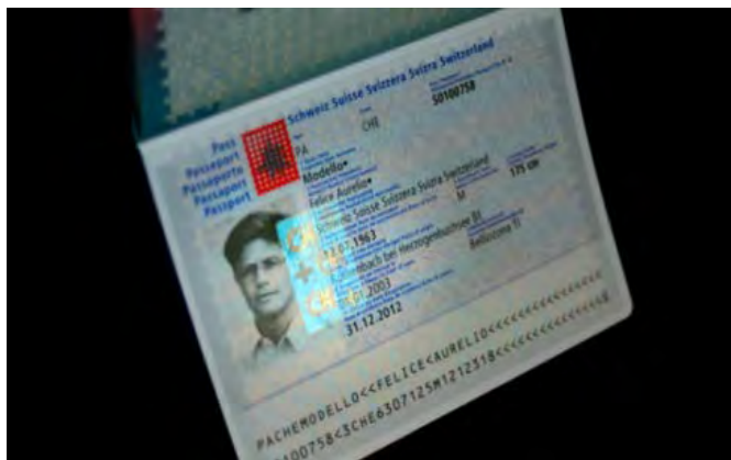
圖 40. 雷射蝕刻穿透過 KINEGRAM 完成人像照片
