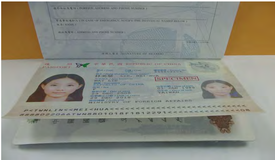
圖 52.2 採用紙張材質資料頁，裝訂於內頁第一張，晶片模組設置於護照封皮內（E-COVER，晶片在封底）
