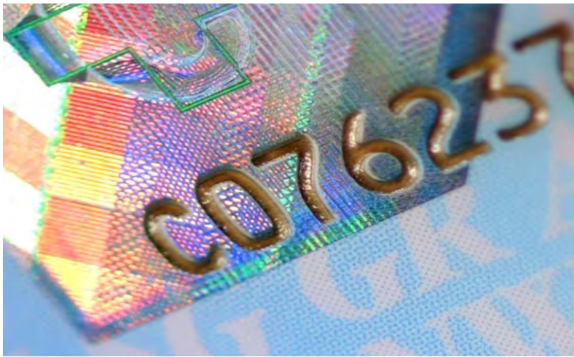
圖 32. 後加工浮凸資料於 Kinegram 之上
