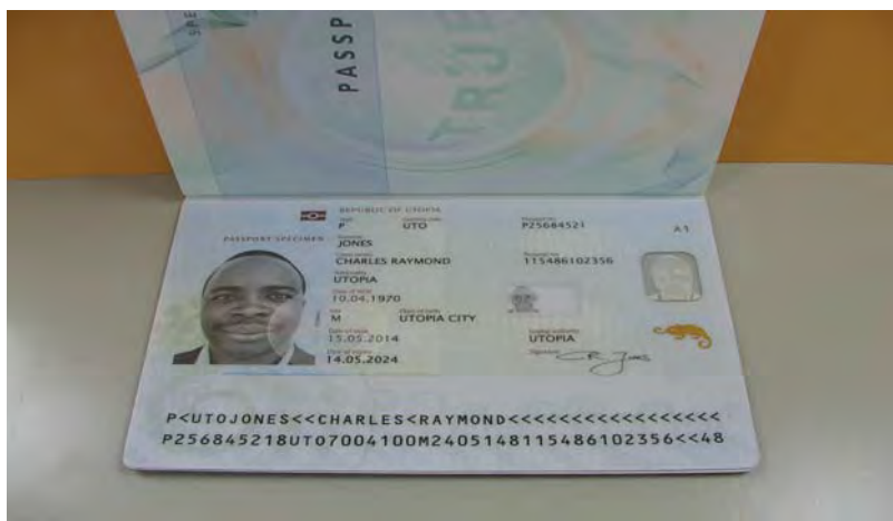
圖 53.2 PC 材質資料頁設置於內頁，晶片及天線模組鑲嵌於內結合為一體
