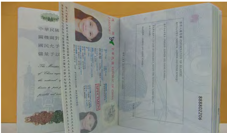
圖 52.1 採用紙張材質資料頁，裝訂於內頁第一張，晶片模組設置於護照封皮內（E-COVER，晶片在封底）
