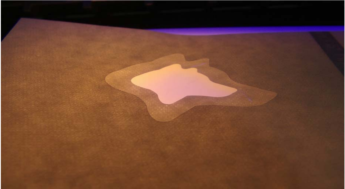
圖 4. Durasafe®複合式具視窗鈔券用紙的 Thrusafe™ windows 穿透視窗
