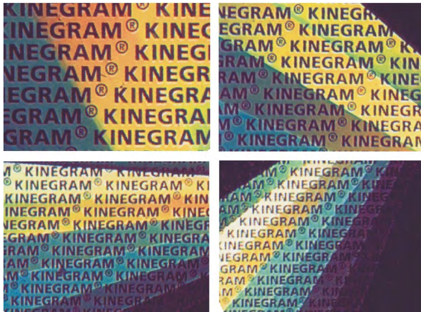
圖 51. 具有奈米微小字金箔產品的延伸功能：具有動態字體大小變化的樣式，以連續
