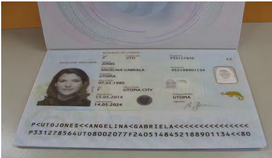
圖 55.1 採用 PC 材質資料頁，裝訂於內頁第一張，晶片模組設置於護照封皮內（E-COVER）
