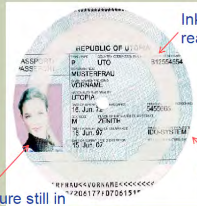
圖 9. Digisafe® 塗層防偽紙張在耐磨褪色抵抗力的測試
