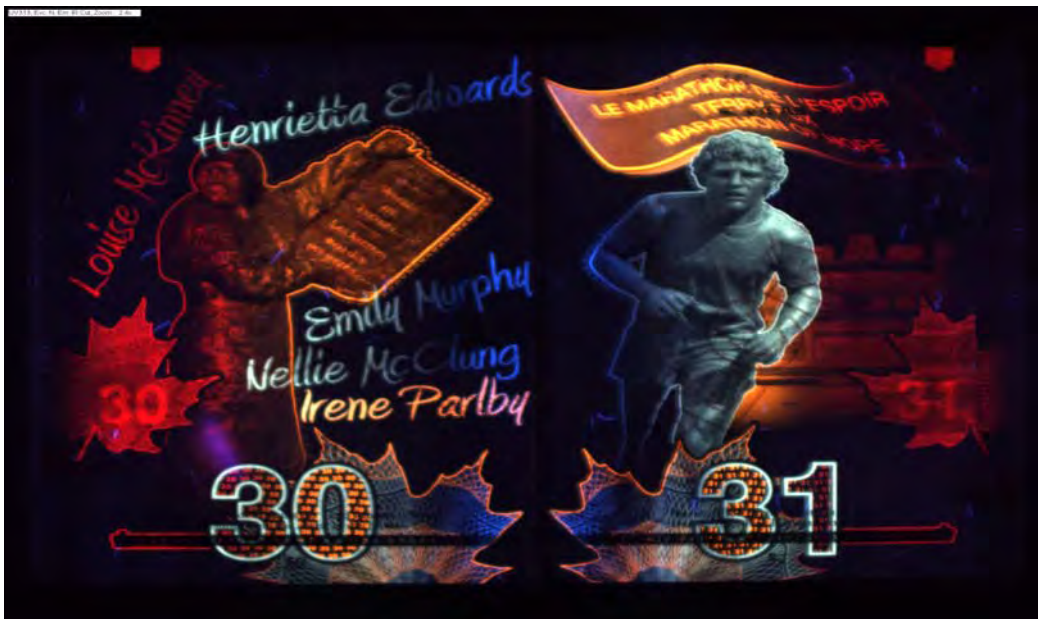
圖 63. 顯性及隱性螢光油墨混用及隱性墨多色套疊及隱性螢光油墨彩虹隔色印刷
