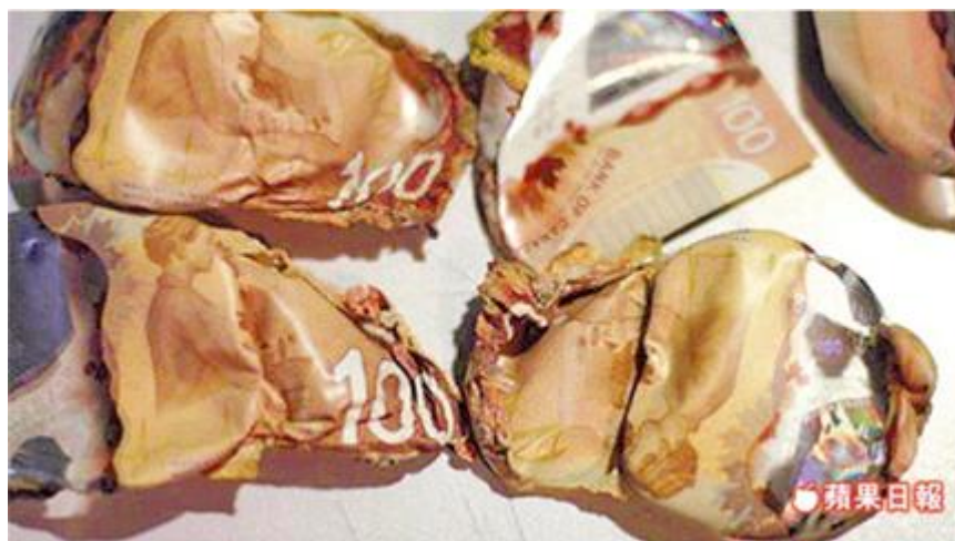
圖 47 塑膠鈔券高溫融化後圖示
