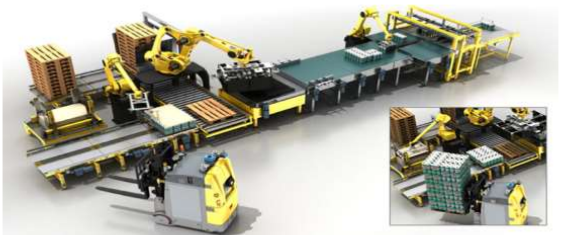
圖 6-1 elettric80 公司的 PALLETIZING ROBOTS 與 AGV
