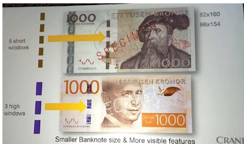
圖 4.96 新舊瑞典克朗上之 Motion®安全線的差異相較
