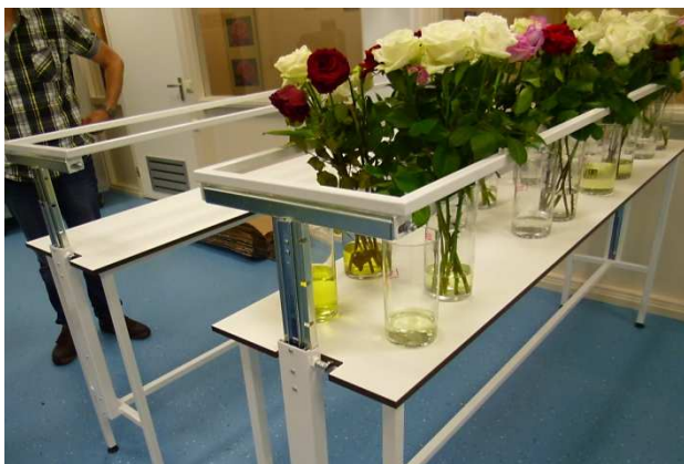
圖 3-3. 桌面可放兩排玻璃瓶，且支架可調整高度，以因應不同切花長度。
