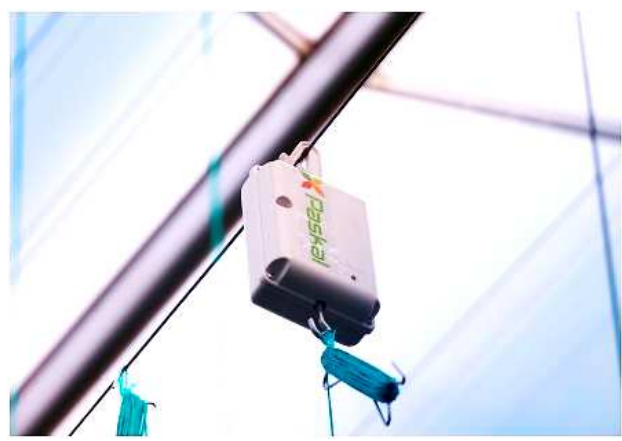
圖 6-6. 番茄植株支撐繩上掛有重量紀錄器，可紀錄分析番茄生長量。(照片由 Delphy 提供)
