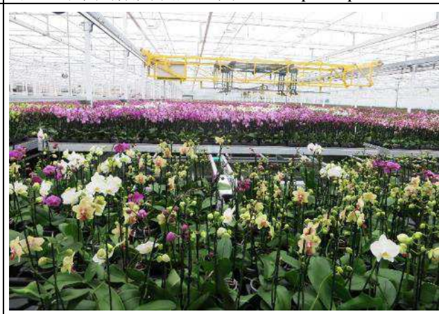
圖 5-26.開花區，上空的盤床移動機可抓取盤床，將要出貨的蝴蝶蘭盆花整床搬至出貨區。
