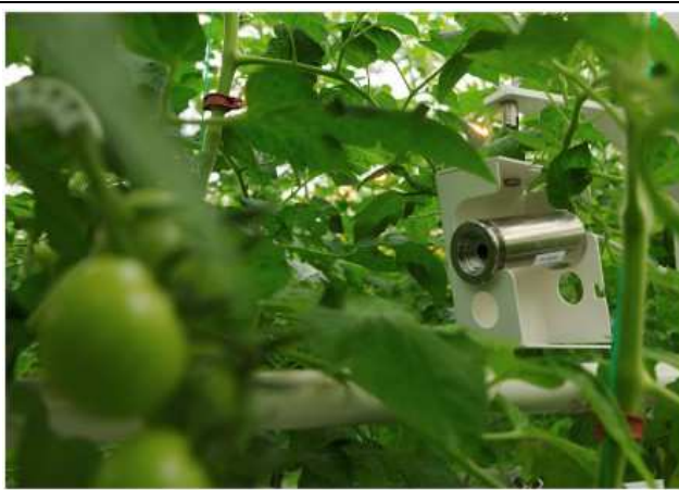
圖 6-4. 番茄栽培溫室內架設紅外線溫度感測儀，監測葉片溫度。(照片由 Delphy 提供)
