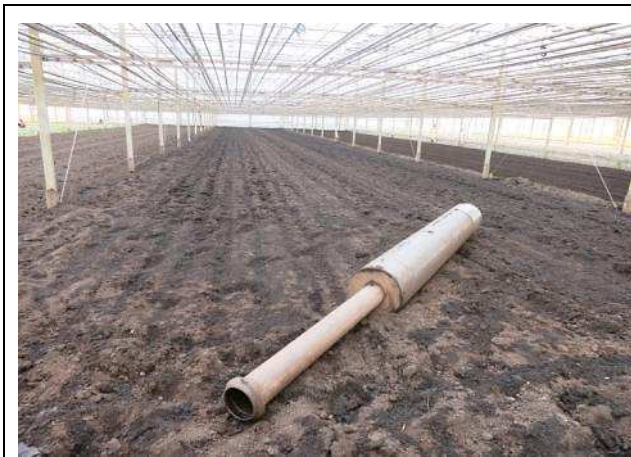
圖 2-17.高溫蒸氣釋放棒，管徑約 30cm，上有許多小孔可讓高溫蒸氣冒出。
