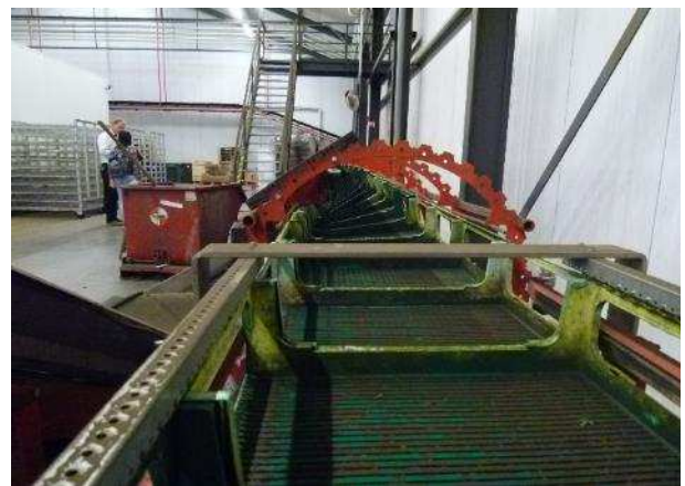
圖 4-28. 菊花生產者種植完的苗箱回收至公司，經輸送帶送往自動反轉倒扣機，清空殘渣標示牌等雜物，即可進行下一次的種植。
