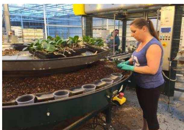
圖 5-3.半自動上盆機，自動充填樹皮及塑膠盆並且圓盤會轉動，再由人工一盆盆種植蝴蝶蘭苗。
