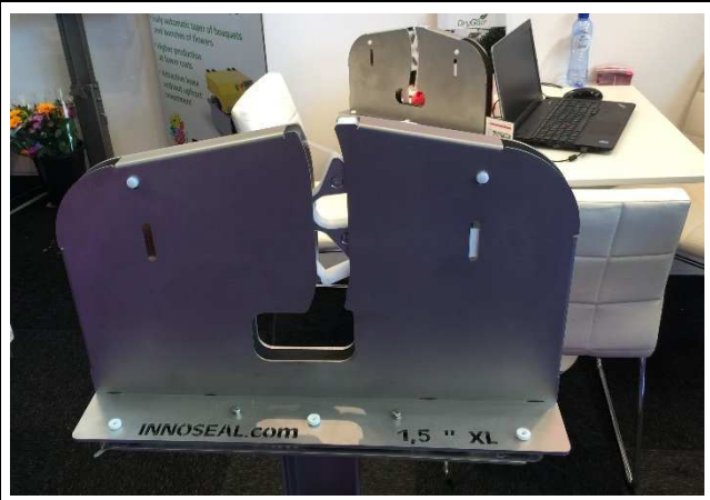
圖 7-4. Royal Brinkman 公司開發的花束省工包裝機，將花束基部由上向下壓，通過滾軸完成網紮。
