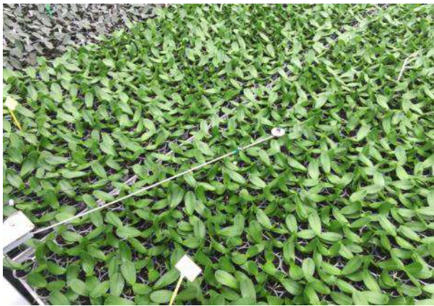
圖 5-15.光度紀錄器，可水平 180 度移動，整棟溫室有 7 枝。
