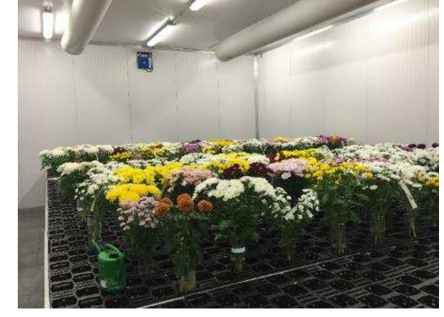
圖 4-8.瓶插實驗室可擺放約 400 瓶切花。牆上有溫溼度感測器，回饋訊號至控制系統自動調整。
