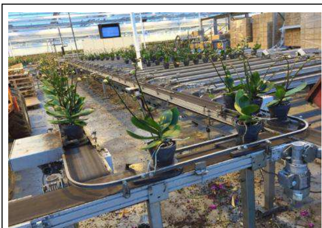
圖 5-21.已抽梗且有成熟花苞的蝴蝶蘭盆花放置於卡盤上自動輸送至整理區。
