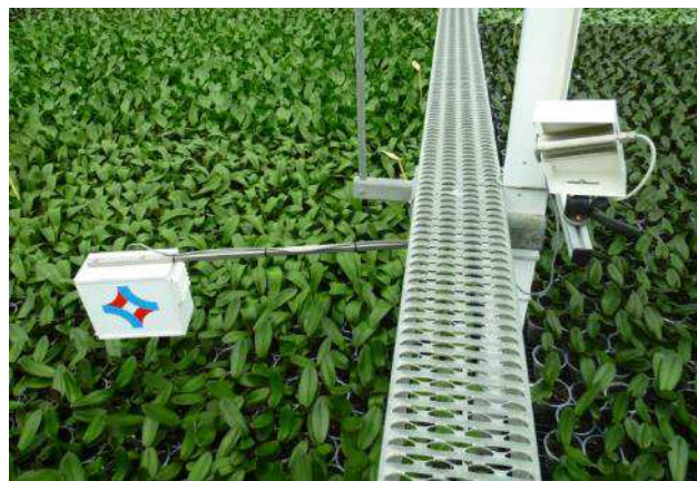
圖 5-14.溫室內的氣象箱，監測溫濕度。右側還有紅外線溫度感測儀監測葉面溫度。
