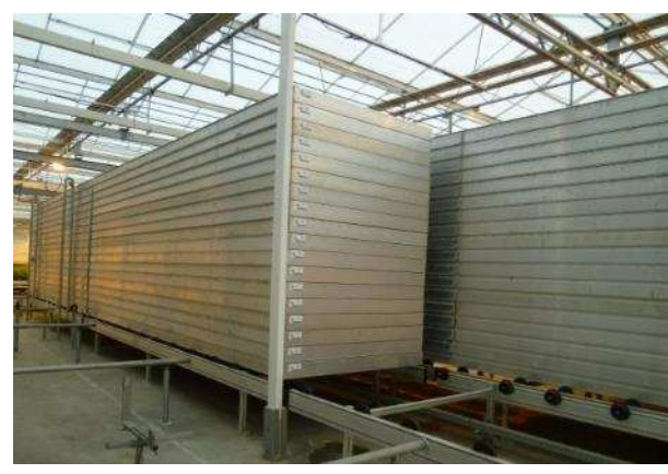
圖 5-4.堆疊的盤床，完成小苗上盆的蝴蝶蘭苗由機械手臂放入盤床，放滿後就移入溫室，下一個盤床就會自動排入等待區。
