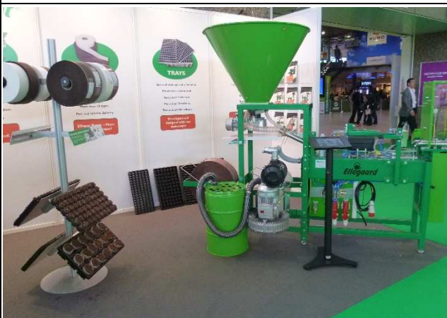
圖 7-18.Ellegaard 公司開發的 Ellepot 系統，以不同不織布包捆介質，栽培時方便拿取。
