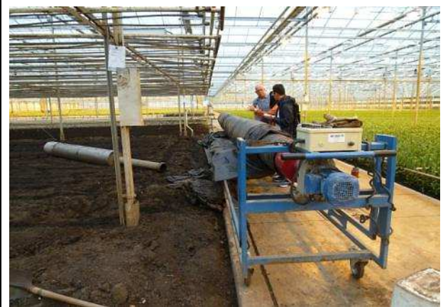
圖 2-20.覆蓋於土面上的黑色塑膠布及其收放滾軸機。黑色塑膠布耐高溫厚度厚，可重複使用多次。
