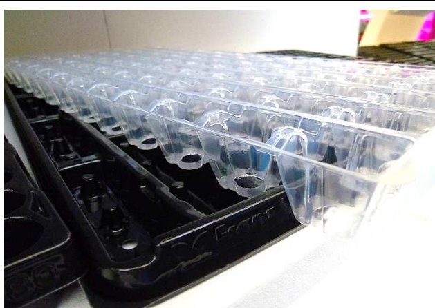
圖 7-17.Modiform 公司雙層育苗盤，下層穴格中央突起，上層穴格底部挖洞，可使穴盤苗脫盆拿取順利。
