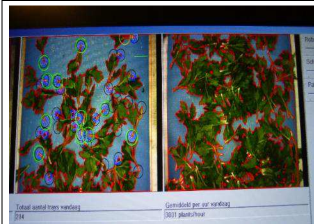
圖 4-13.自動扦插機透過攝影機影像辨識插穗基部，由機械手臂抓取插穗基部放上扦插平台。
