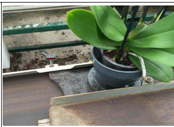
圖 5-22. 卡盤均有感測器，所以電腦可紀錄每盆的分級規格。
