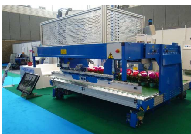
圖 7-15.盆花田間自動擺放機，為 Degravec 公司開發。
