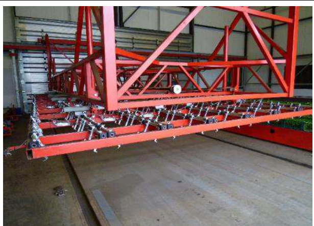
圖 4-18. 一平台可放置 161 苗箱，共 16,744 苗。此照片為平台機械手臂，可一次抓取一平台的 161 個苗箱。
