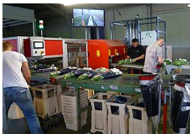
圖 2-36.自動化機械進行套袋，工作人員再進行裝箱，將花束放入立式容器插水。立式容器也是由自動化機械推送擺放。
