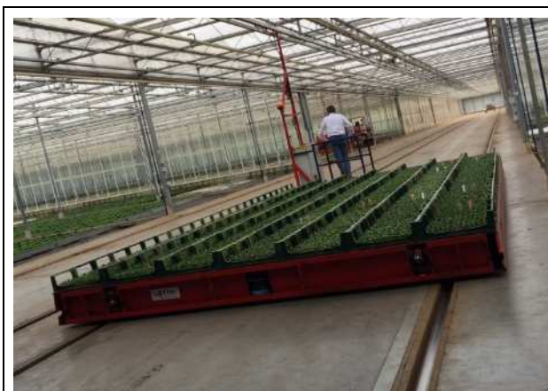
圖 4-19. 161 個苗箱放於平台上經由中央軌道輸送車送至溫室。再由其他自動機械將此 161 個苗箱搬移至溫室左右兩側適當田間位置。
