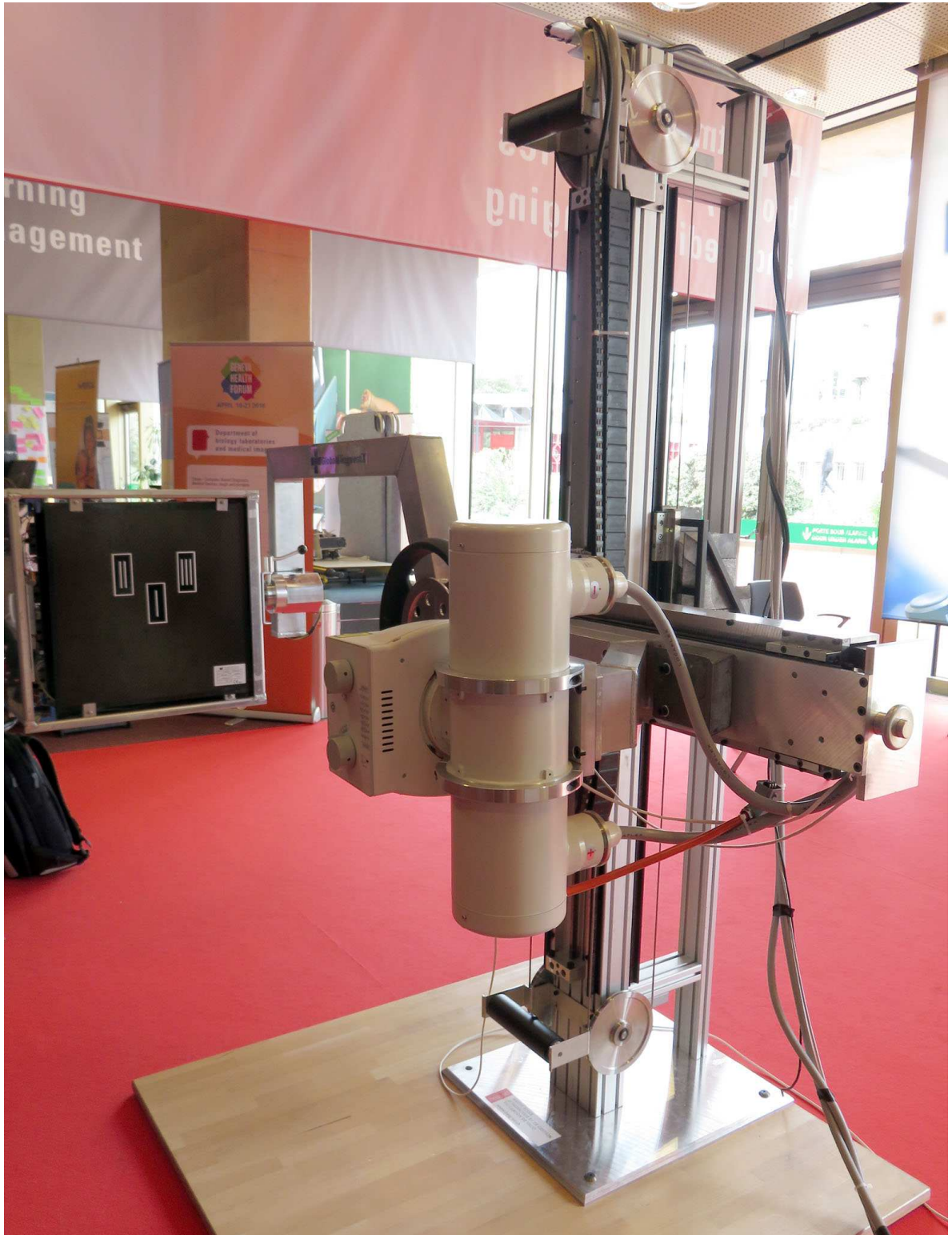
全球診斷 X 光機計畫 (GlobalDiagnostiX) 概念原型展示機 (電子底片、影像處理、機械結構及電力系統)
