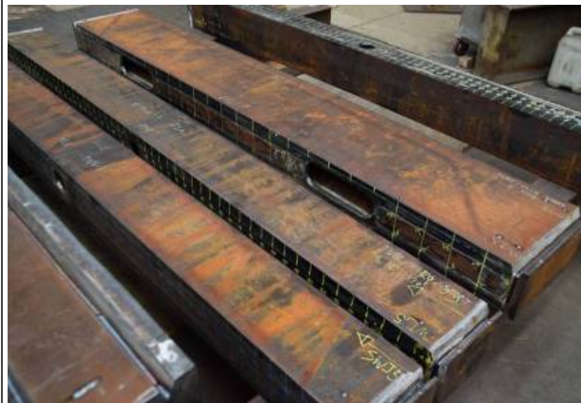
空氣冷卻器 header(待鑽孔與管束連結)
