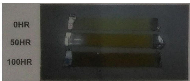
圖 2 ABS 樹脂板經不同程度耐光性測試之變質發黃的樣品
