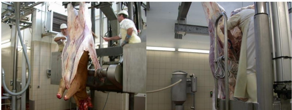
(圖 33. 屠宰場中牛隻剝皮及除去內臟之步驟常造成大腸桿菌污染。圖片來源：摘錄自課程講義)
