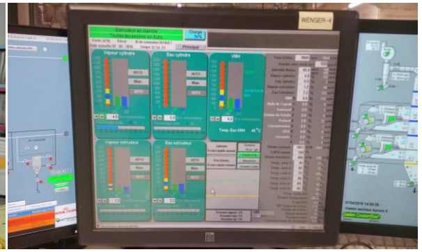
圖 10、電腦控制其溫度及製程
