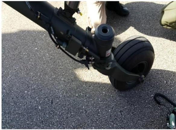
圖 3. 尾輪於實施訓練時不慎插銷斷裂
