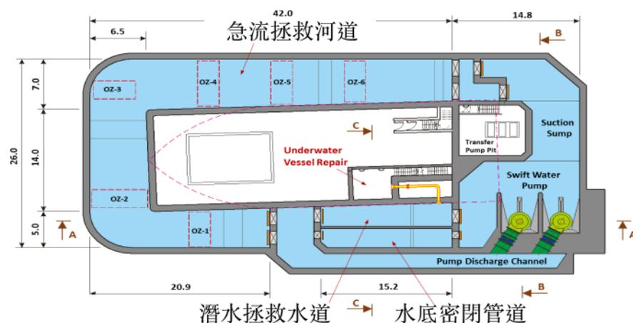
圖 9 急流水道設計示意圖
