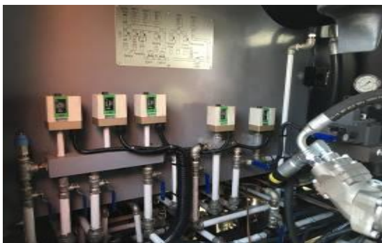
位於調動機左側後方的單閥輔助風缸(25L)
