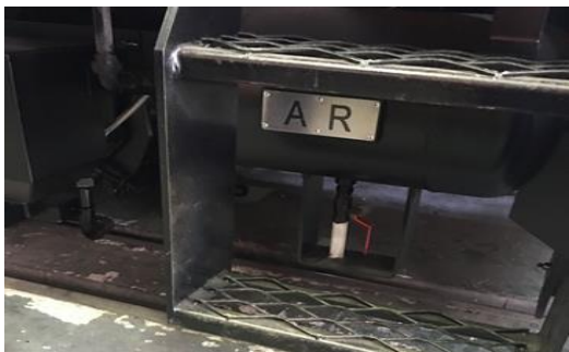
位於調動機左側後方的單閥輔助風缸(25L)
