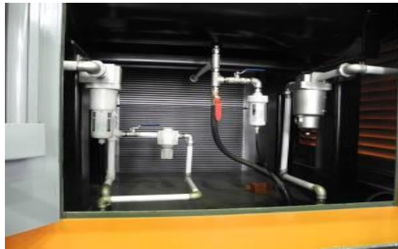
位於調動機左側前方的停留軔機輔助風缸(25L)
