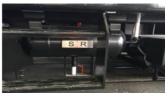
位於調動機左側前方的停留軔機輔助風缸(25L)
