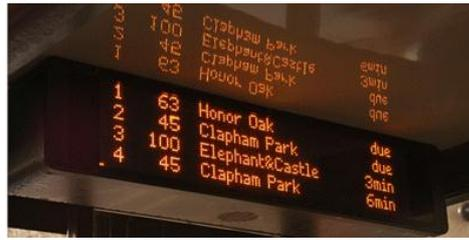
iBus 系統在站牌有公車到站時間倒數(如上圖所示：到站次序、路線編號、終點站以及到站時間)，同時提供網頁版服務以及先前提及的 app 服務。倫敦市區有將近 2,500 個公車站牌，iBus 系統普及率還沒有到 100%，約 1,900 個站牌配有舊的系統。如果路上有事故發生，也可以利用 iBus 系統通知駕駛員以及乘客。
