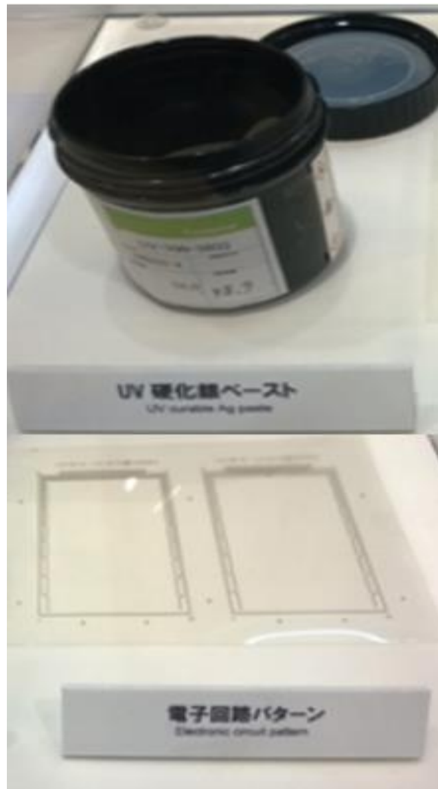
圖 26 日本田中貴金屬工業株式會社開發之 UV 硬化網印用銀膠
