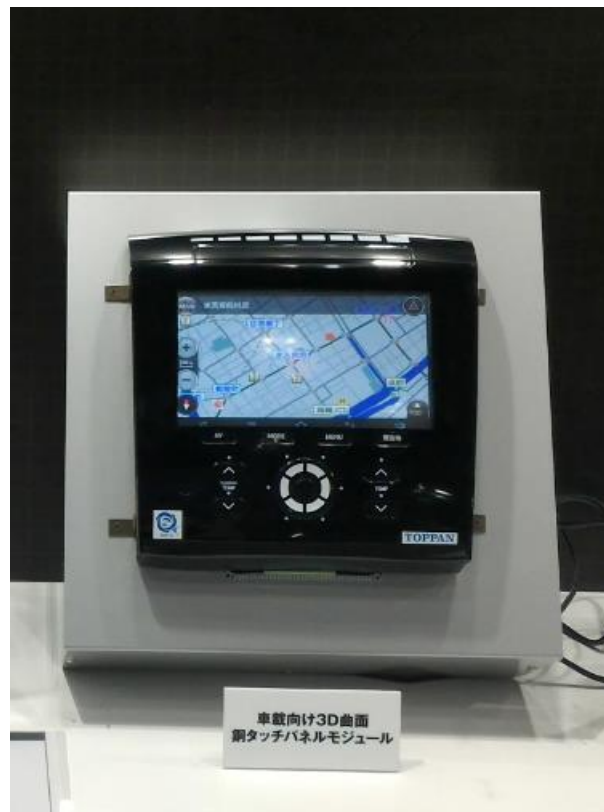
圖 13 日本凸版印刷(TOPPAN)公司推出以銅做為電極材料的 3D 曲面觸控螢幕
