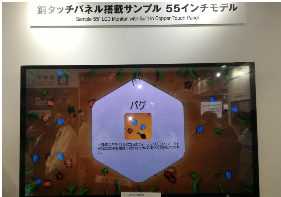
圖 12 日本凸版印刷(TOPPAN)公司推出以銅做為電極材料的 55 吋觸控螢幕
