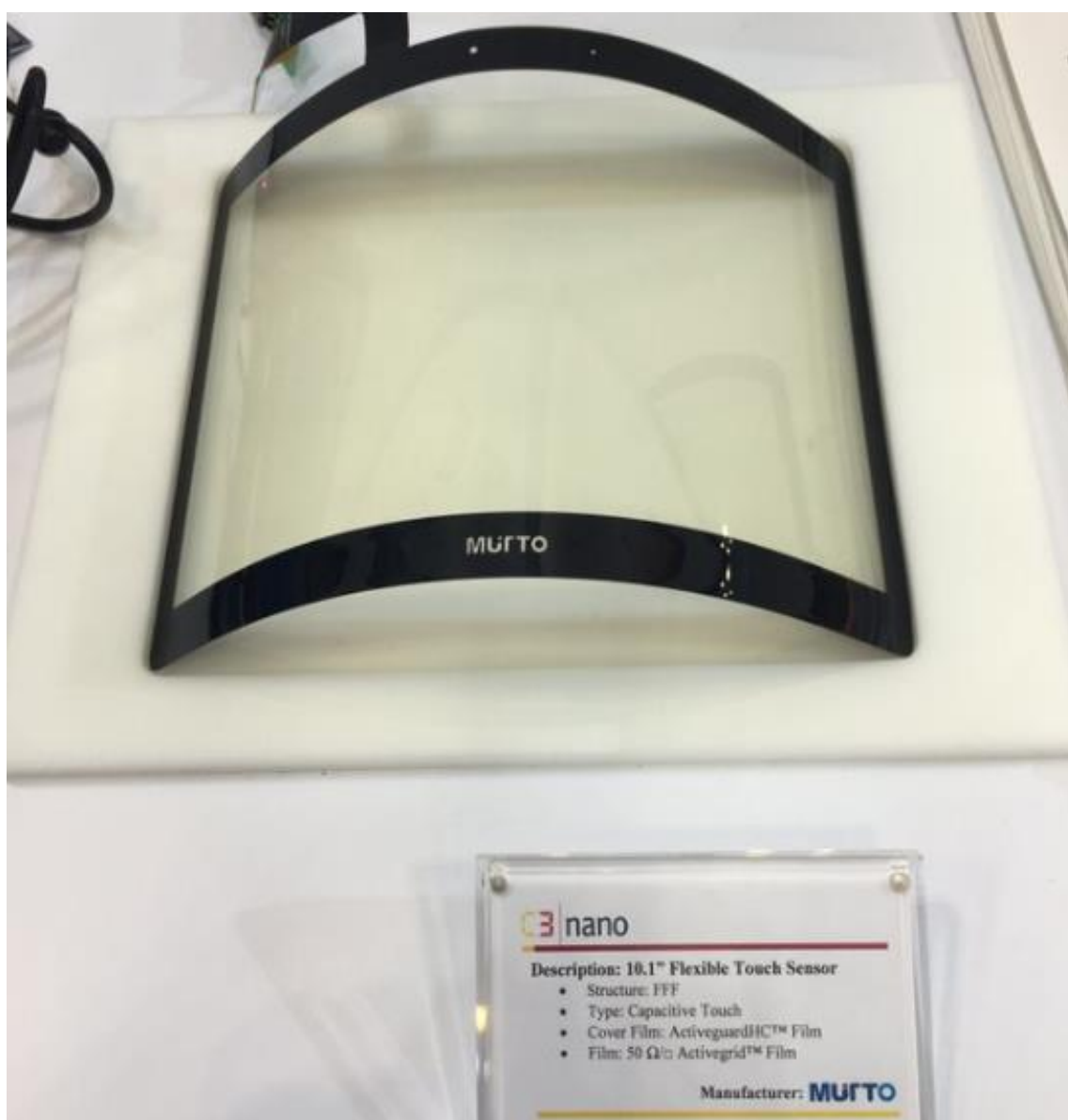
圖 10 C3nano 公司開發之奈米銀線透明導電薄膜
