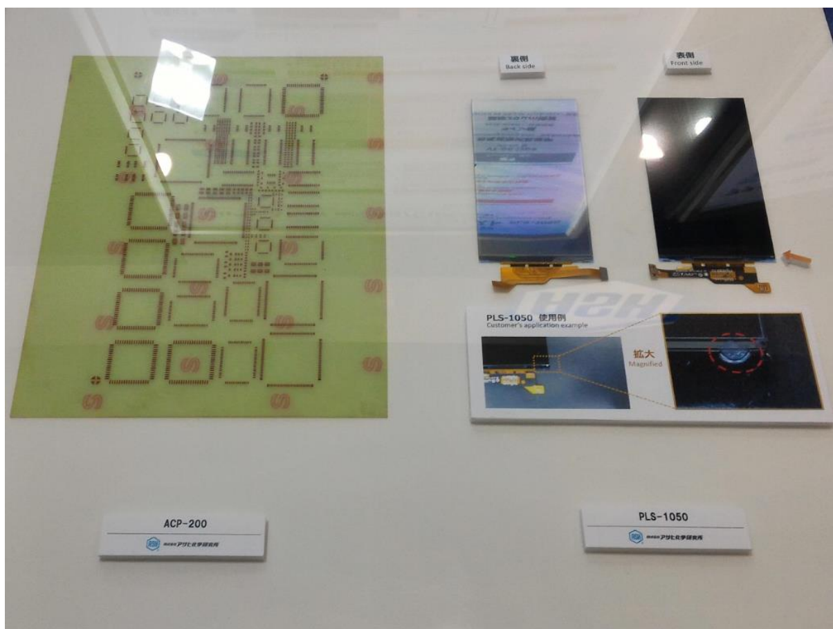
圖 20 Asahi-kagaku 公司最新開發之銅膠(ACP-200)以及銀銅殼核結構導電膠 (PLS-1050)展示品
