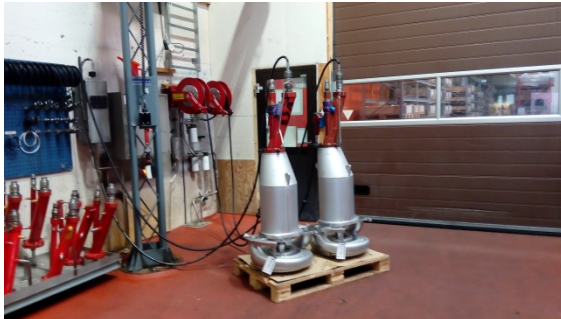
貨油泵測試前準備(液壓泵添加液壓油)
