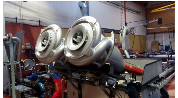
貨油泵測試完成後將泵內液壓油釋放
