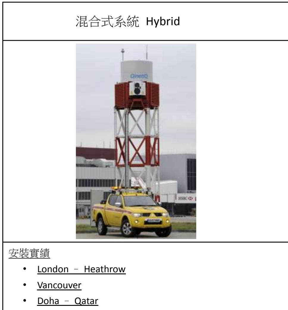
圖3.2 英國Tarsier系統塔式偵測器
