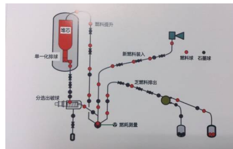
圖2、高溫氣冷核子反應器燃料循環示意
