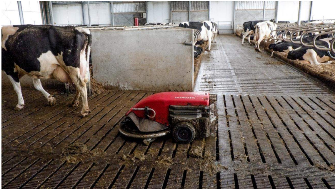
圖十一、清潔機器人將乳牛排泄物推至溝槽下。
