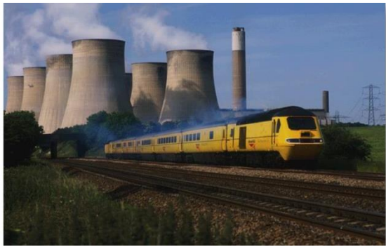
圖27.高速軌道檢測-3
