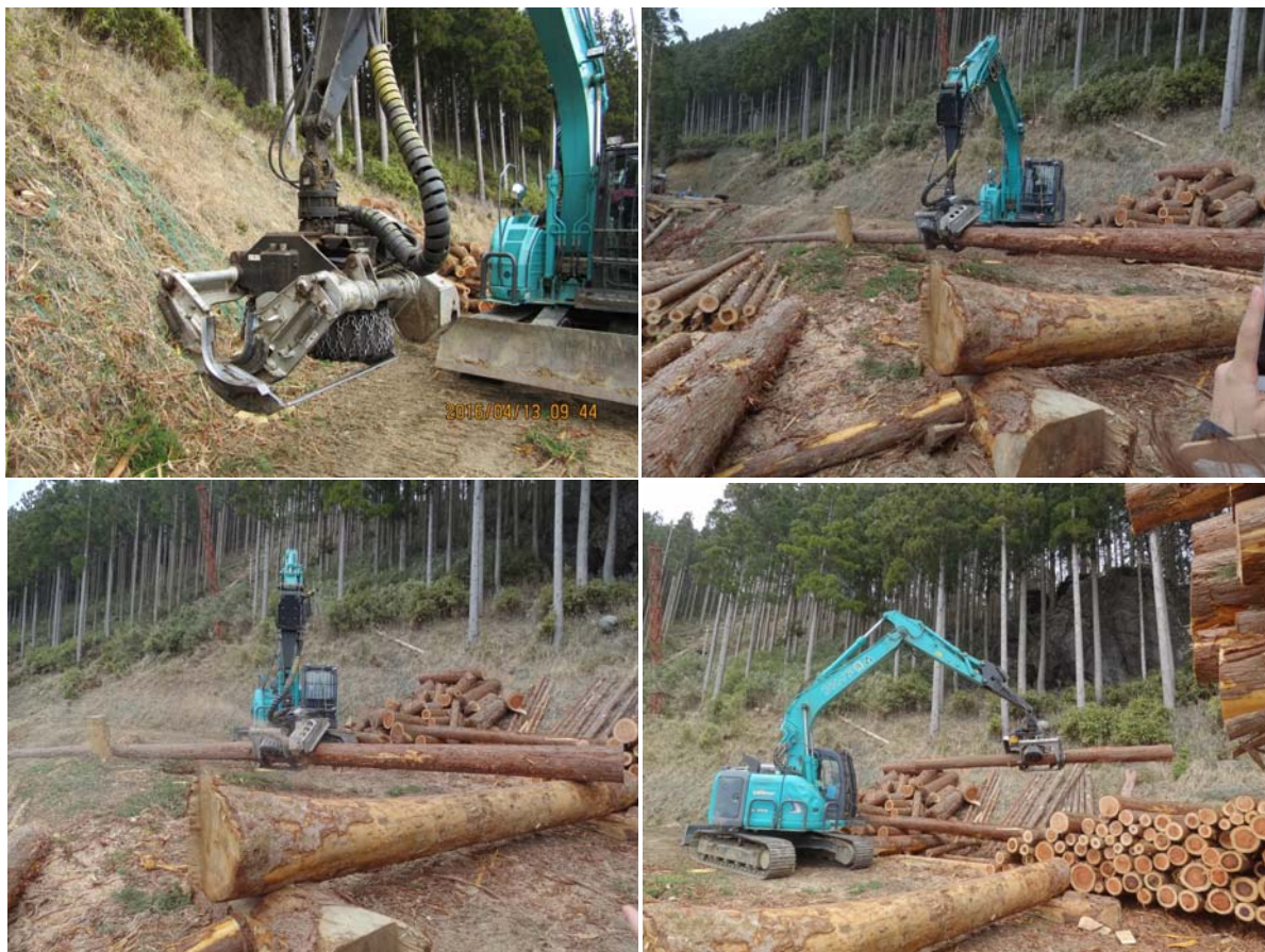
照片 9：高性能造材處理機可打枝、量測材積、造材鋸切、夾取原木整理、整地等多項功能。
