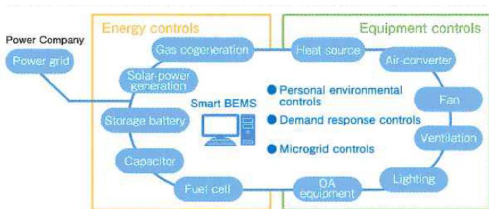
圖29、清水建設技術研究所的智慧建築能源管理系統(BEMS)概念
