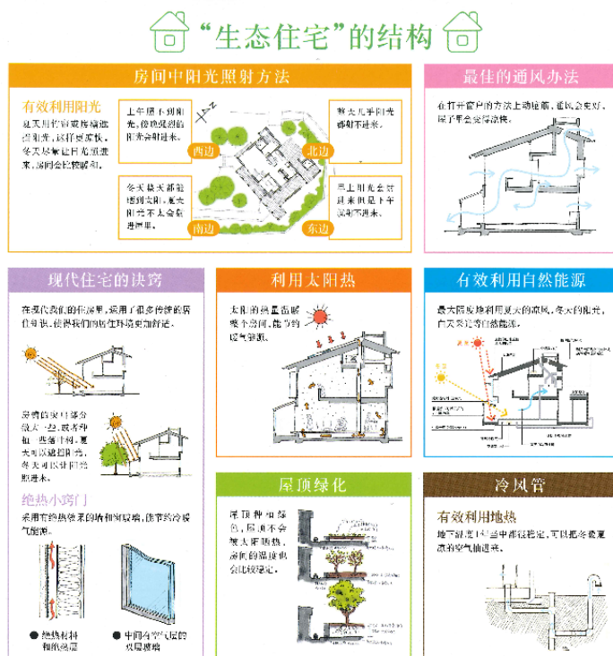
圖39、生態屋結構設計技巧
