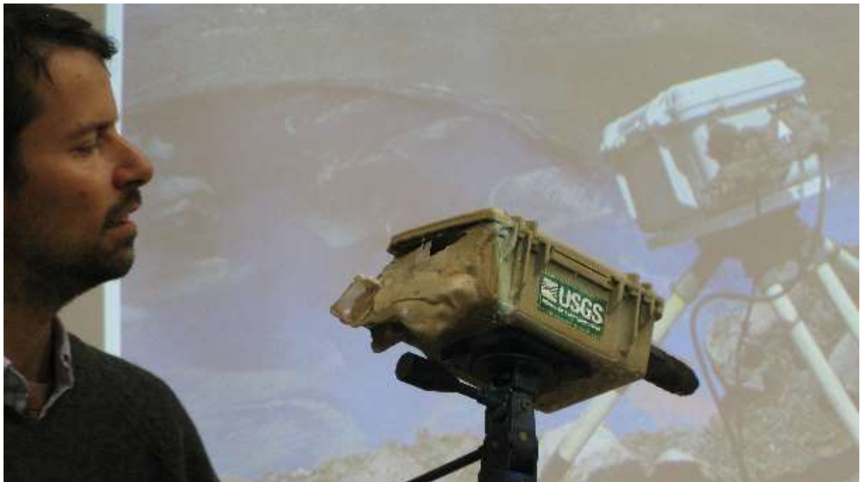
HVO 專家介紹火山監測，圖中為被熔岩高溫毀損之設備。
