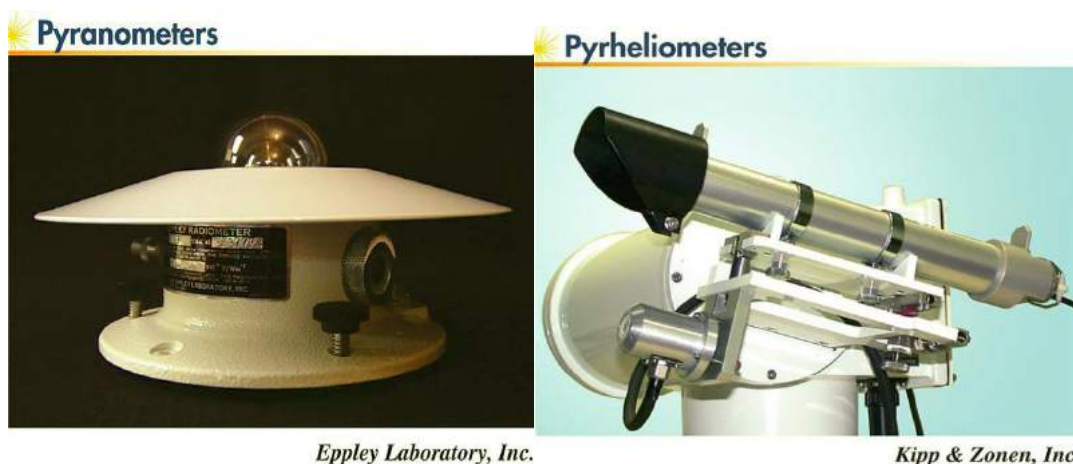
圖 69 太陽輻射測量儀
