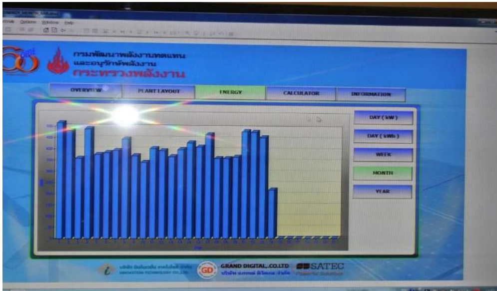
圖 109 使用 BEMS 即時監控大樓用電情形
