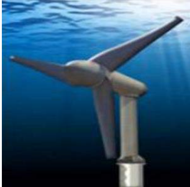
圖 43 水平軸渦輪機示意圖
