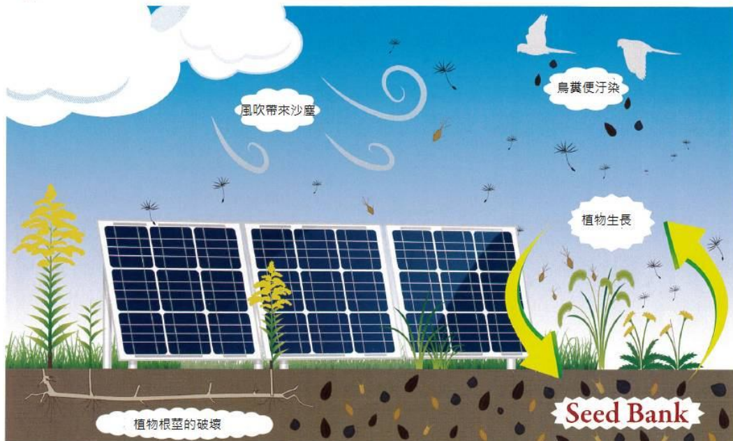
圖 3、太陽能發電設備需要維護的原因 (資料來源：廠商文宣品，丸善藥品產業株式會社)
