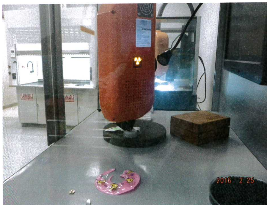
圖 12 高精度 X-射線螢光光譜儀(HDXRF)檢測過程 2
