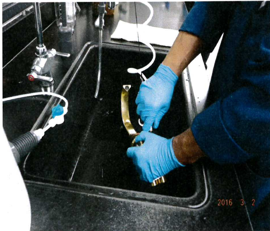
圖 24 調節過程-萃取水的注入
