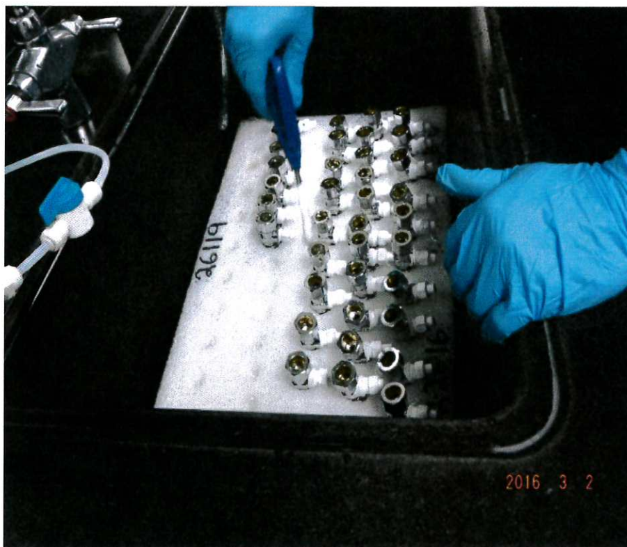
圖 25 水側配件的調節過程-萃取水排空與注入
