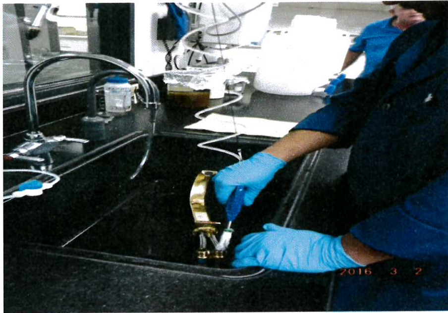
圖 23 調節過程-萃取水的排空
