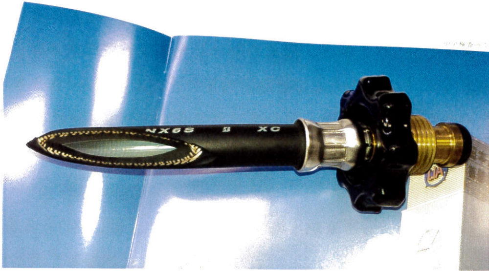
圖 9 日本高壓瓦斯橡膠管剖斷面之內層塗佈樹脂情形
