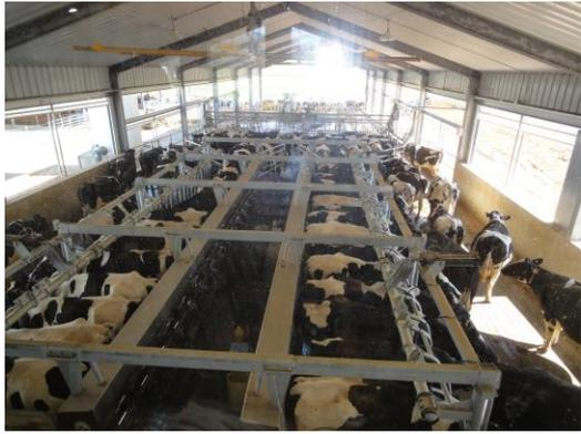
圖 13. 大型牧場賽馬式擠乳設備
