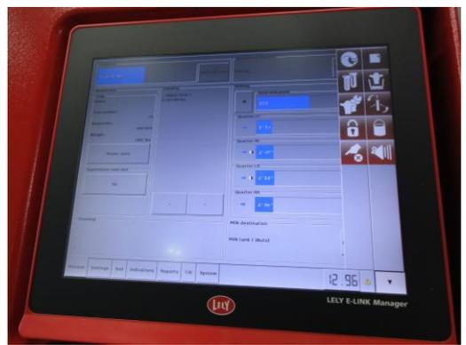
圖 18. 機器人擠乳過程中自動紀錄個別乳牛之乳量
