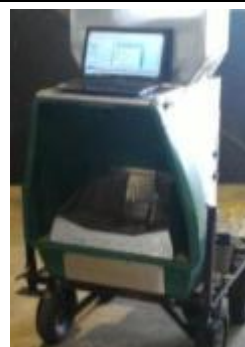
Greenfeed 機器設施
