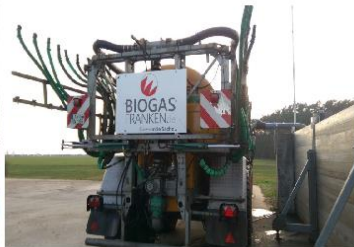
圖 18. 施灌槽車抽取沼渣
