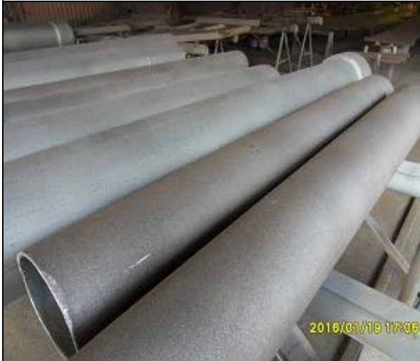
管材表面處理
