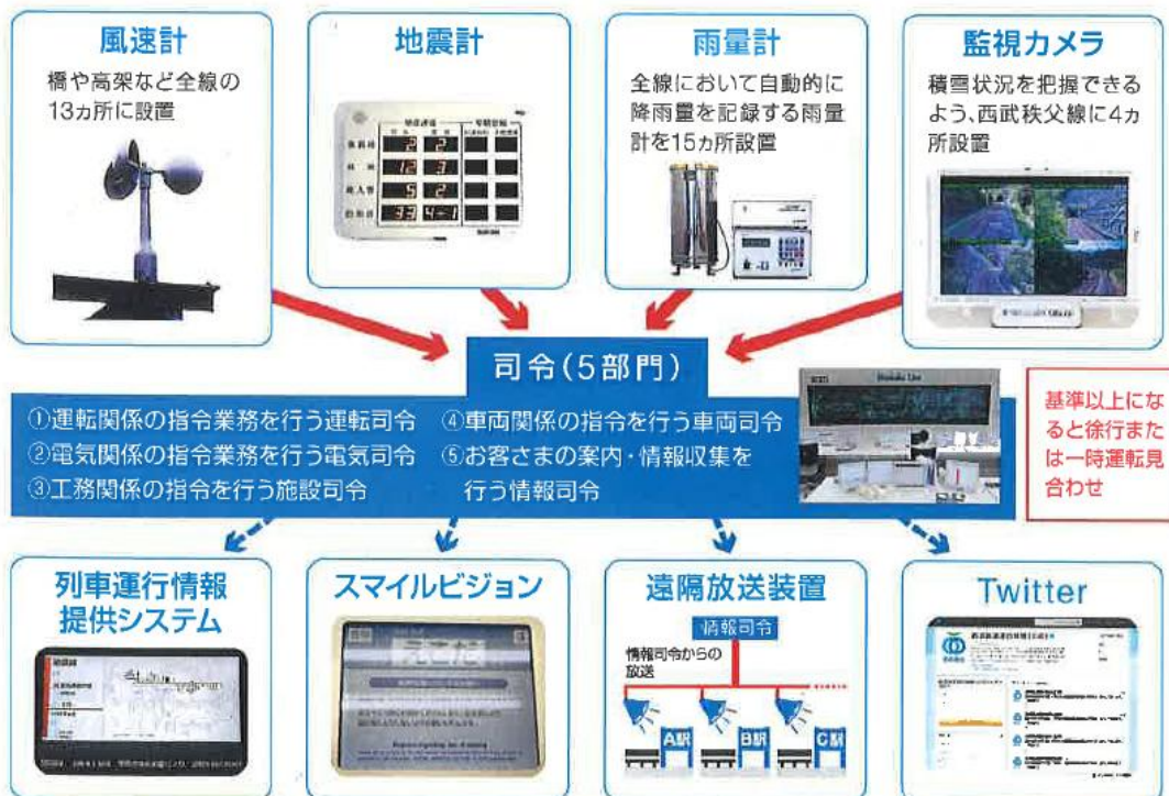
圖 21 防災監測預警系統
