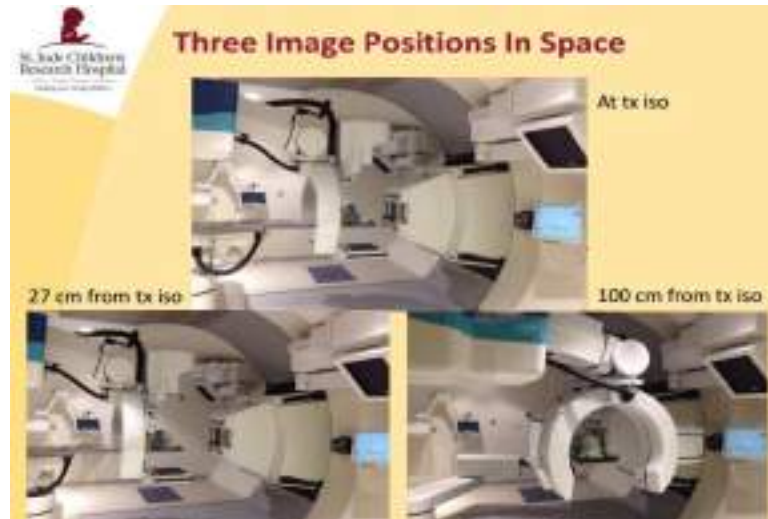
圖十一、搭載 C-Arm 影像擷取裝置空間位置
