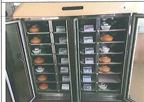
圖 6 可設定溫度的保冷/保溫餐車
