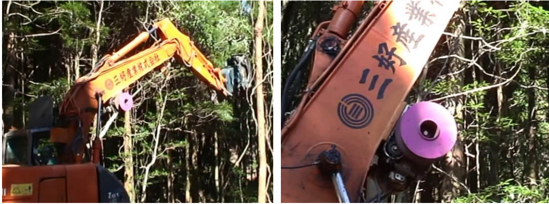
圖 18 以迴旋式集材機進行集材作業(該集材機具 1 捲胴)。
