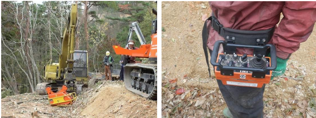
圖 9 自走式遙控搬器(背後為原木抓取機)及遙控器
