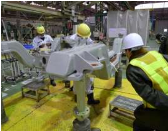
圖 3-13 轉向架組裝作業
