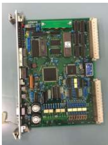
圖 4-20 CPU-12 車體傾斜角控制計算單元
