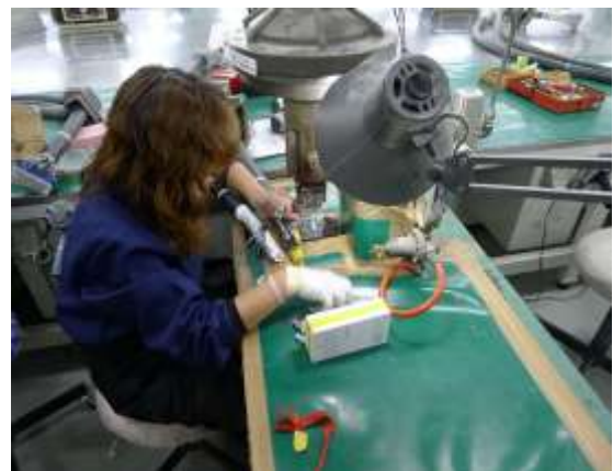
圖 3-11 壓接端子專門壓接機器
