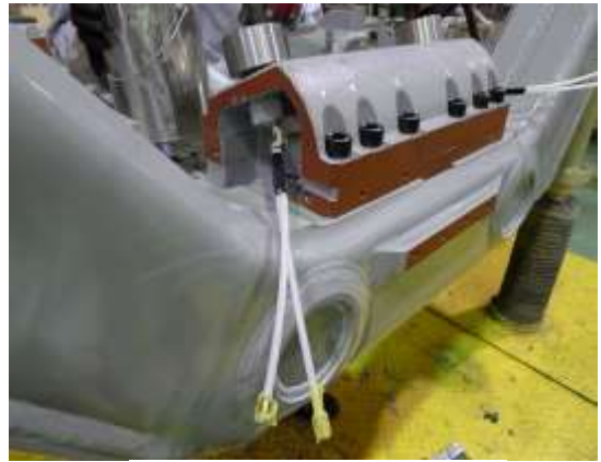
圖 3-14 傾斜樑注油管
