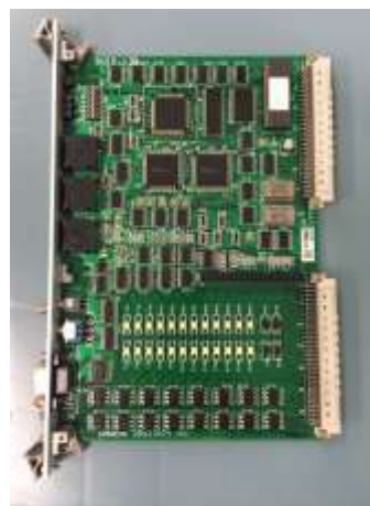
圖 4-21 BUF6-13B CC 裝置、CPU 電路板傳輸控制、車輛編號控制單元
