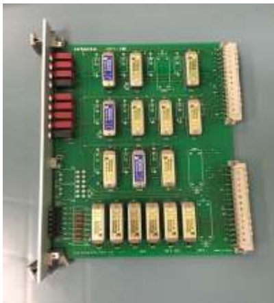
圖 4-16 ARU-10 輸入、輸出輔助繼電器單元
