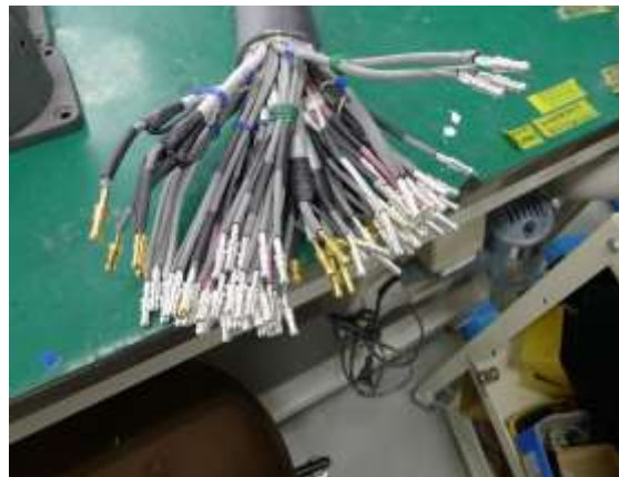
圖 3-12 隔離線、電源線、控制線壓接端子
