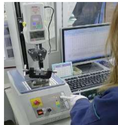
圖 3-10 壓接端子耐拉力試驗
