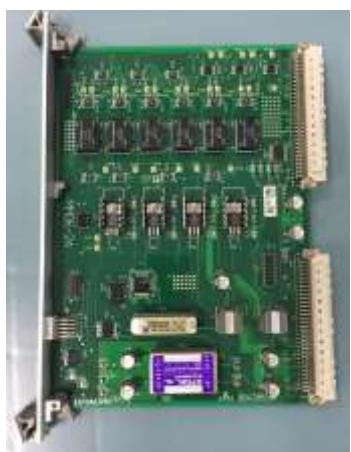
圖 4-22 MMD6-2A 與 CC 裝置之間的傳輸接口
