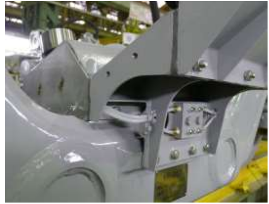
圖 3-18 注油管至注油孔路徑
