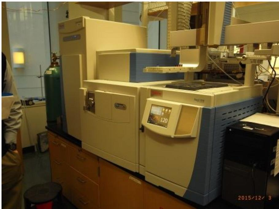
圖 5、Thermo Q Exactive GC-MS/MS 儀器外觀。
