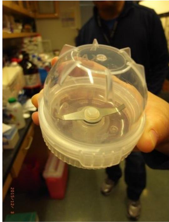
圖 6、IKA Tube Mill 控制型試管研磨器(左)與研磨杯(右)外觀。
