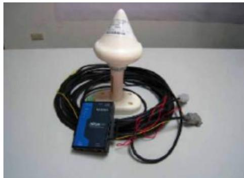
圖 34 單頻 GPS 設備價格便宜，設置較為容易，精實測發現在 3km 距離內透空情形良好下，1 小時觀測時間段所得基線成果與雙頻 GPS 相當(陳鶴欽，2009)，若我們能在有雙頻連續站的約制下，可讓成果達到具連續性且可用的觀測精度。
