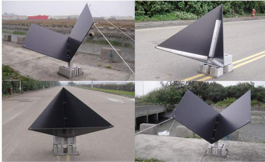
圖 36 PSISAR 使用的角反射器材質具有良好的金屬反射特性，可依載具與觀測的波長來進行設計(C、L、X-Band)，提供影像優良的幾何控制條件。
