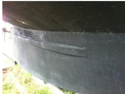
整體式龍骨冷卻器實照
