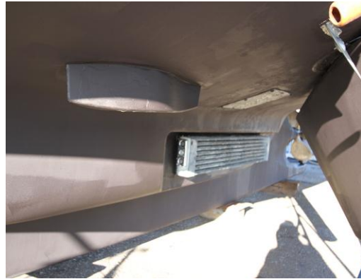
非整體式龍骨冷卻器示意圖
