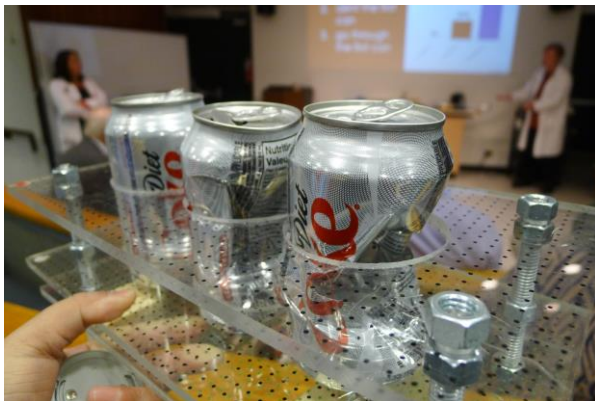
乒乓球由原本真空的管子後來空氣進入後，射穿了第一鋁罐，打凹了第二個鋁罐
