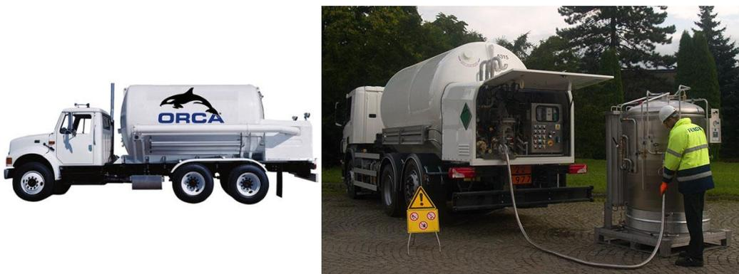
液化天然氣帶泵加液車適用於加液需求量較少的「點狀市場」，2013年查特公司受中大陸國家質檢總局特種設備局委託，進行ORCA車先行測試，通過
