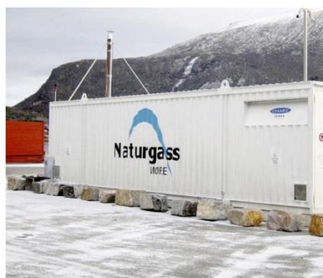
查特公司1995年推出LNG箱式加注設備，2012年2月於北京潞城建立了大陸首座箱式加注站，經3年安全操作，是一種利用貨櫃內裝加注設備，可作為機動性LNG加注使用，儲罐和LNG加注設備可通過螺栓連接固定，也可分別拆裝運輸，便於整個裝置的轉移，在現場佈置上也十分方便。
