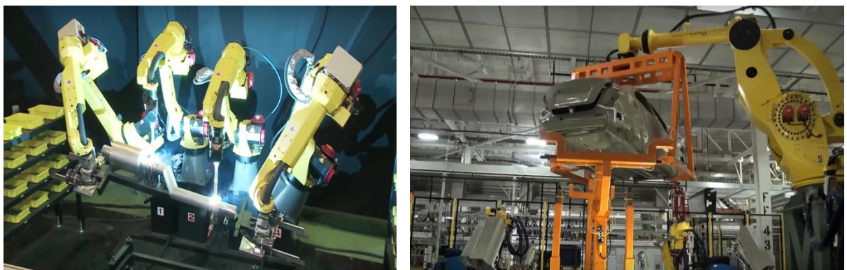
圖5 多軸連動機器人與高荷重機器人 1
