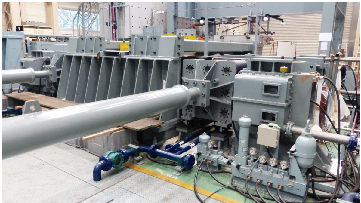
圖 32 強震動發生器樣品承載震動台、連動桿與照片左側阻尼器
