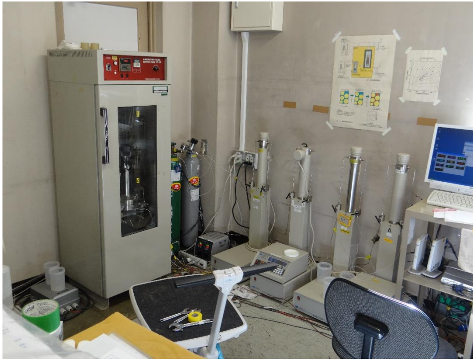
圖 35 CRIEPI 二相流相對滲透率實驗設備現場概況
