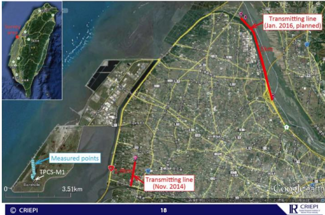
圖 40 可控源音頻頻率大地電磁探查發射端之傳輸線與接收端之量測點布置圖
