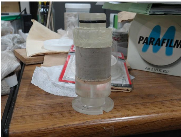
圖 38 二相流電阻試驗岩心標本製作
