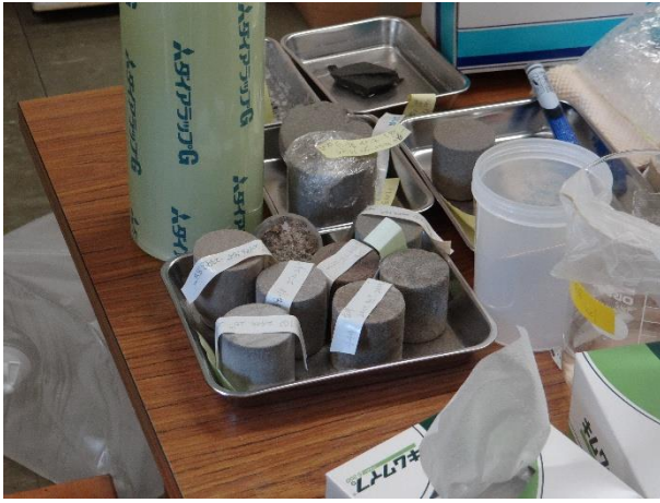
圖 37 二相流相對滲透率試驗垂直與水平岩心標本削切製作
