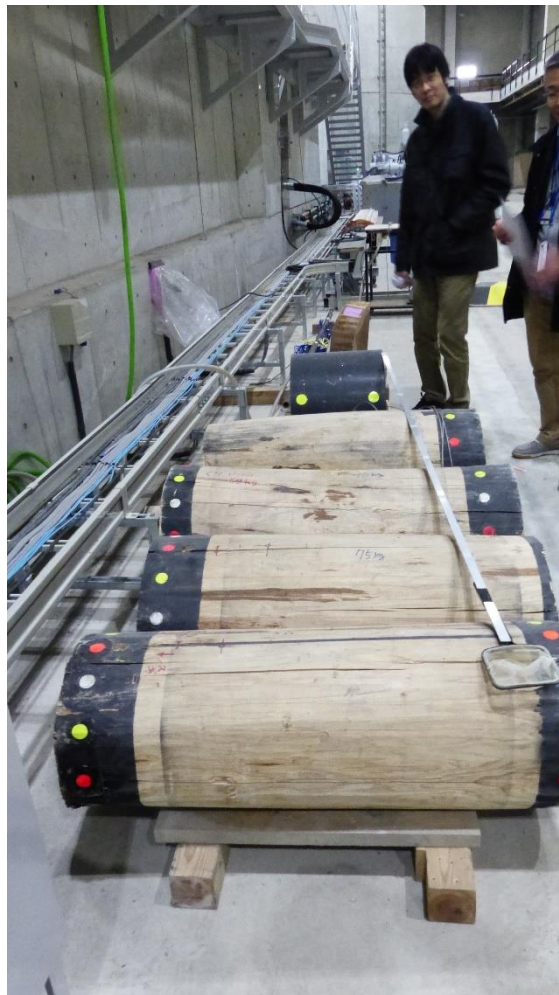
圖 29 置放在海嘯物理模擬器試驗水路中之漂流木
