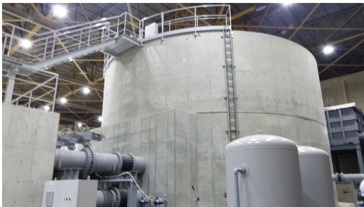
圖 27 海嘯物理模擬器水頭水槽與控制段水路連接之流量調節閥門管線
