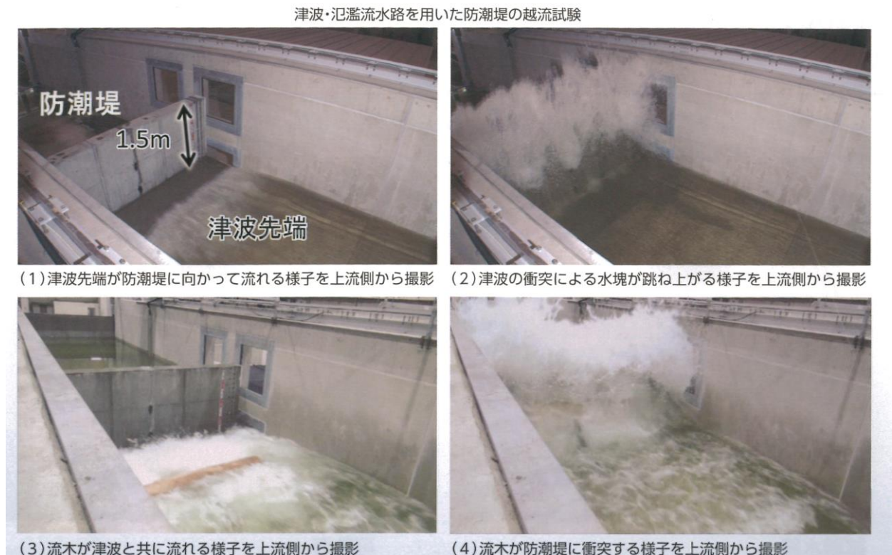
圖 25 大尺度海嘯物理模擬器海嘯牆之海嘯易損性實驗
