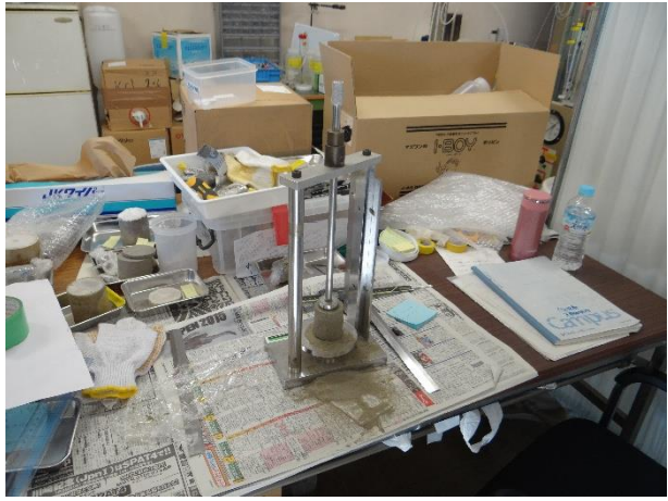
圖 37 二相流相對滲透率試驗垂直與水平岩心標本削切製作
