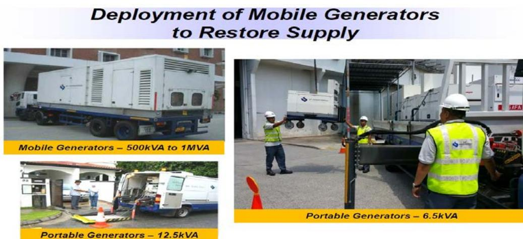
圖 18 配置行動發電機因應事故停電以加速復電縮短停電時間
