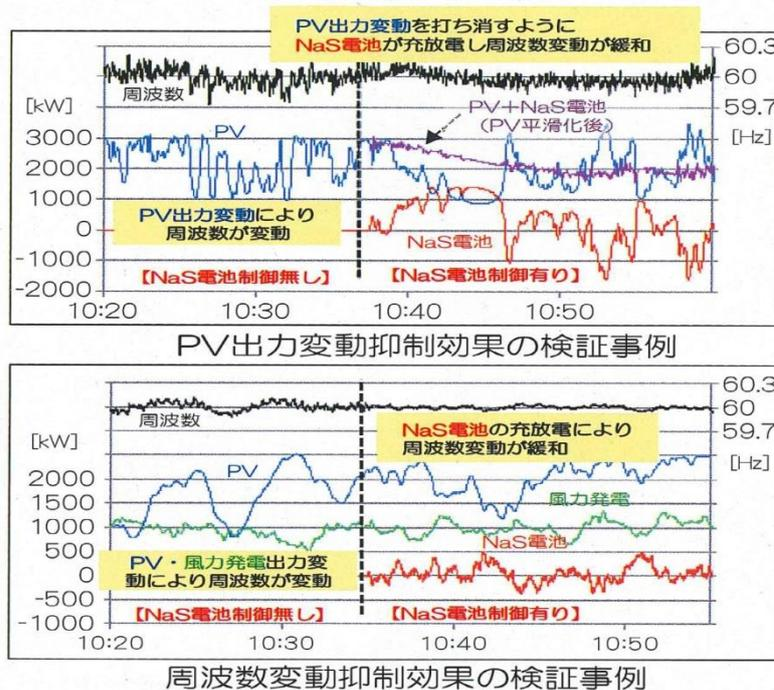
圖 10、宮古島 NaS 電池儲能系統控制計畫
