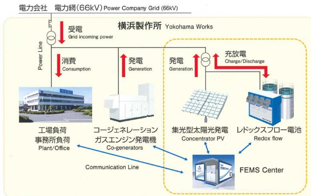
圖 3、橫濱製作所內 FEMS 系統架構圖
