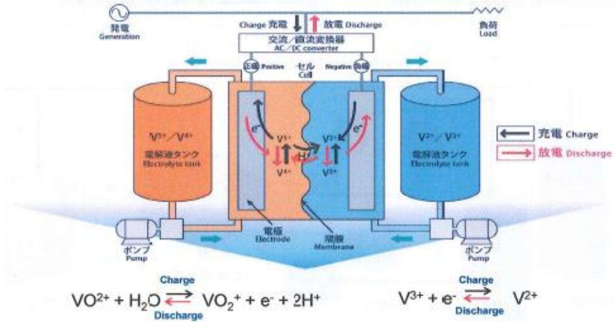
圖 2、全釩氧化還原液流電池(VRFB)工作示意圖
