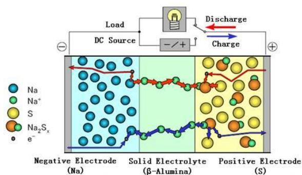
圖 9、鈉硫電池運作原理圖
