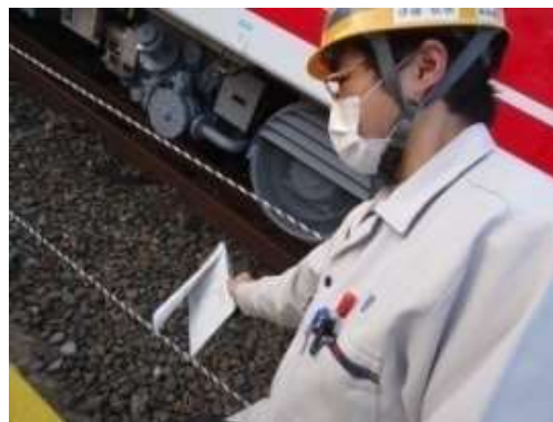
圖 2-32：確認風扇轉數增加風向正確
