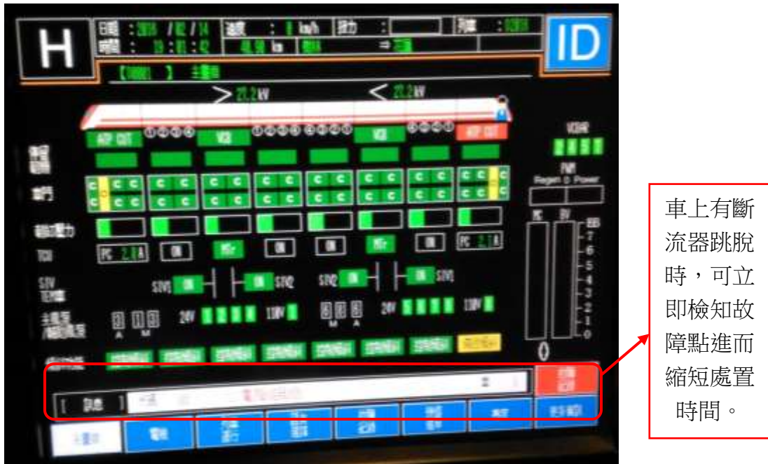
圖 3-11：TILT 電源斷流器跳脫檢知畫面
