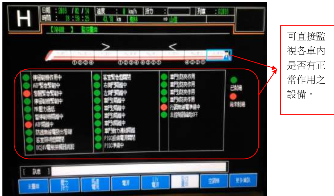
圖 3-10：各車上應正常作用設備監視畫面
