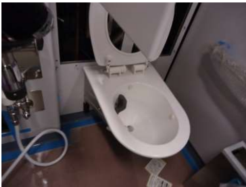
圖 2-19：便盆裝水到觸動水位感應器
