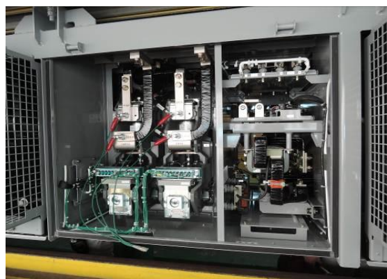
圖3-61 A,AK接觸器迴路模擬接線
