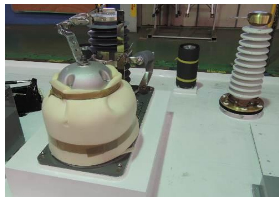
圖3-36 VCB總成安裝
