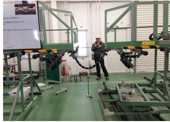
圖3-73 電氣跳線偏倚試驗
