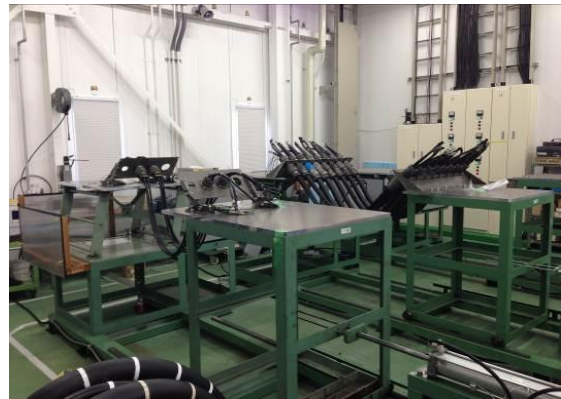
圖3-76 電氣跳線在試驗裝置上擺動
