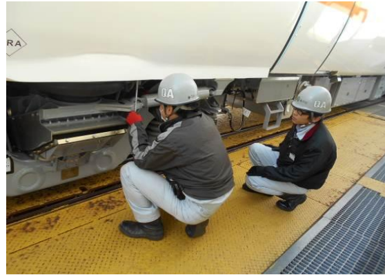
圖3-40 車下空簧高度量測(208~210mm)
