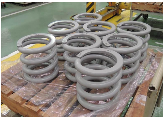
圖 3-10 轉向架一次簧組裝前檢查 (同轉向架誤差 2mm 以內)
