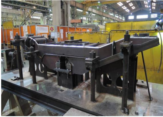
圖3-6 轉向架傾斜樑組配焊接作業
