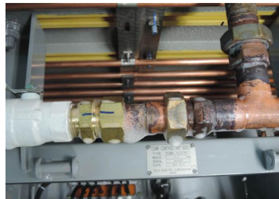
圖3-42 TEM1025管路洩漏試驗檢視
