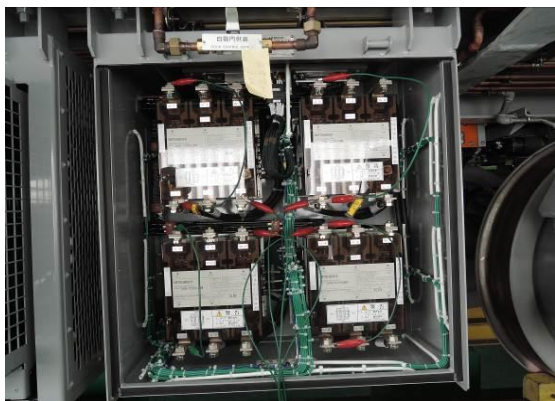
圖3-60 牽引馬達接觸器迴路模擬接線
