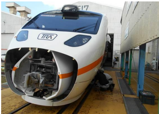
圖3-53~54 車體轉向架模擬曲線過彎偏倚量測試
