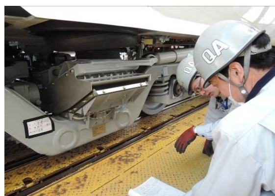
圖3-47~48 TEPCO1025車體轉向架模擬曲線過彎偏倚量測試
