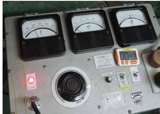
圖3-67 高壓電路耐壓試驗
