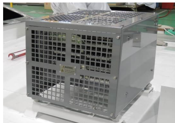
圖3-38 車頂插入電阻安裝確認
