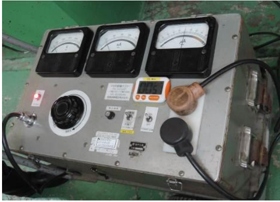
圖3-66 一般電路耐壓試驗
