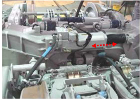
圖4-10 傾斜控制缸安裝控制車體傾斜
