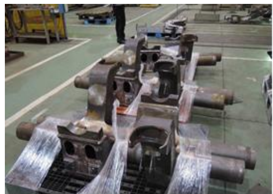
圖3-3 轉向架橫樑部分已焊接之半成品
