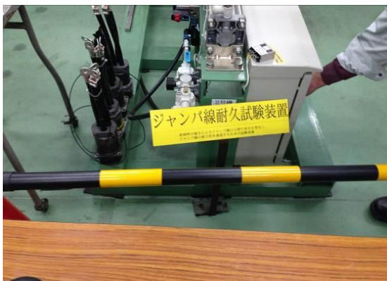
圖3-75 跨接線耐久試驗裝置
