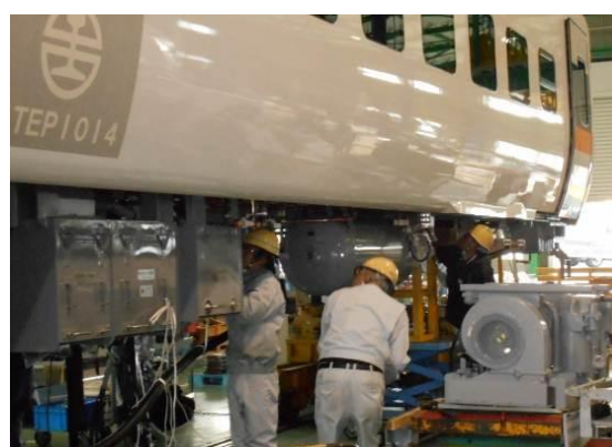
圖3-24 車下設備元件及管線安裝
