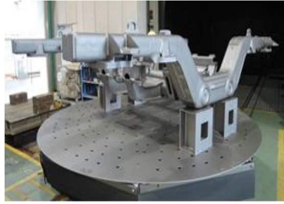
圖3-7 轉向架退火加工及噴砂作業
