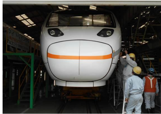
圖3-46 TEPCO1014車身橘色線條塗裝中
