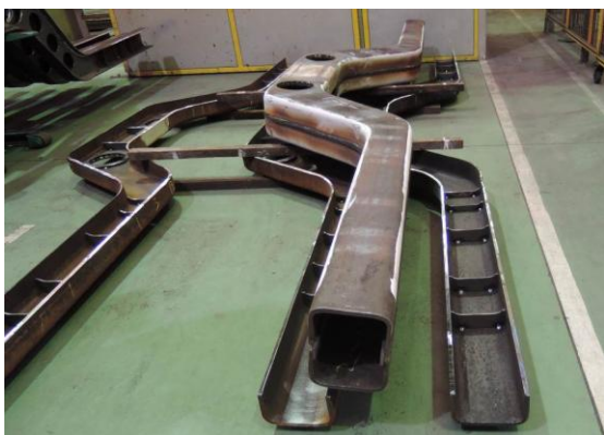
圖3-2 轉向架側樑部分已焊接之半成品
