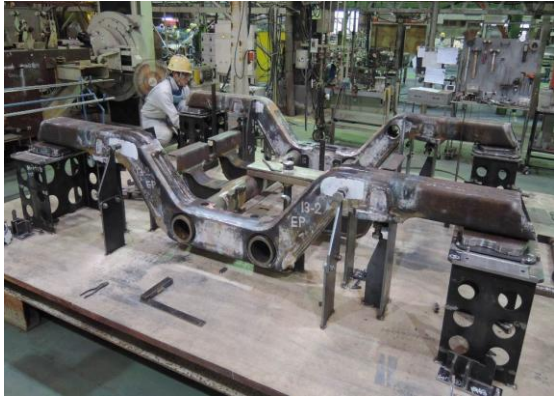
圖3-4 側樑及橫樑在模具上組配焊接固定
