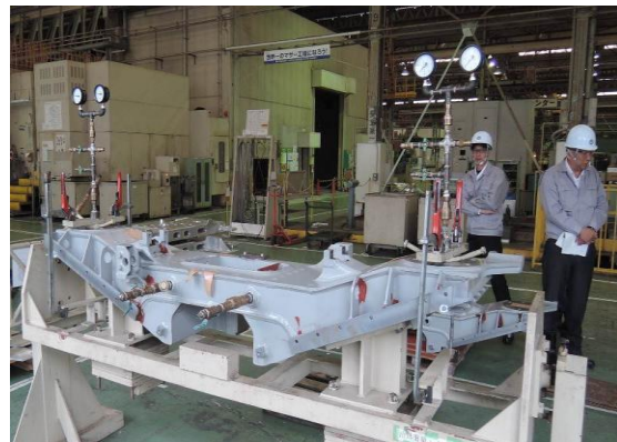
圖3-9 轉向架傾斜樑之氣密試驗
