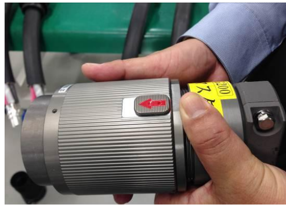
圖3-84 插旋式電氣連結器操作
