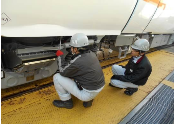
圖3-49~50 車體轉向架模擬曲線過彎偏倚量測試檢視
