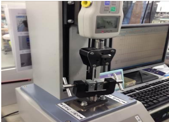
圖3-72 線材抗拉強度試驗
