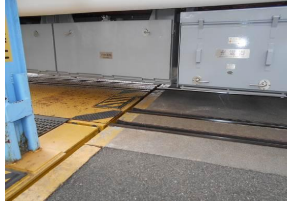
圖3-49~50 車體轉向架模擬曲線過彎偏倚量測試檢視
