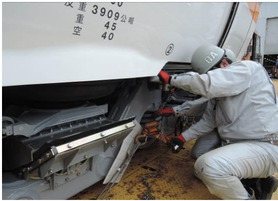
圖3-51 車體轉向架模擬曲線過彎傾斜
