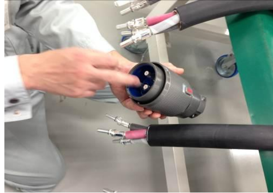
圖3-86 高壓插旋式電氣連結器組裝
