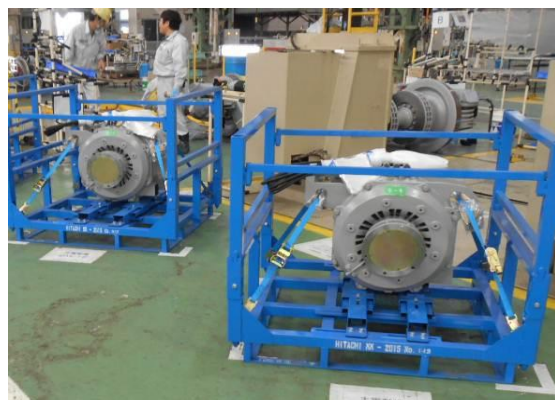
圖3-19 轉向架組裝元件整備(牽引馬達)
