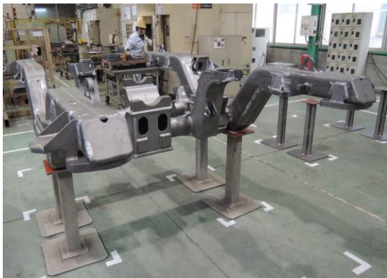
圖3-8 轉向架表面研磨修整作業
