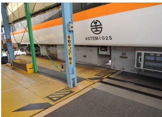
圖3-47~48 TEPCO1025車體轉向架模擬曲線過彎偏倚量測試
