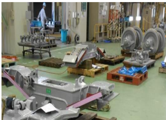
圖3-18 轉向架組裝元件整備
