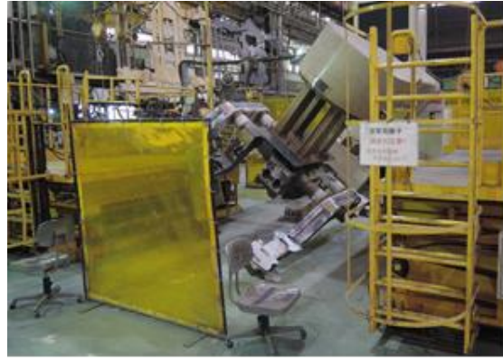
圖3-5 側樑及橫樑焊接由機器手臂完成
