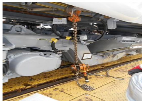
圖3-53~54 車體轉向架模擬曲線過彎偏倚量測試
