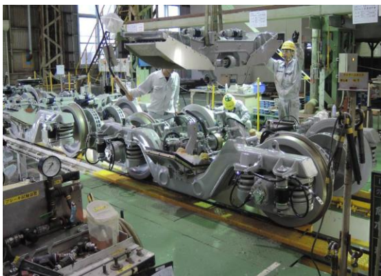
圖3-15 轉向架傾斜樑之安裝
