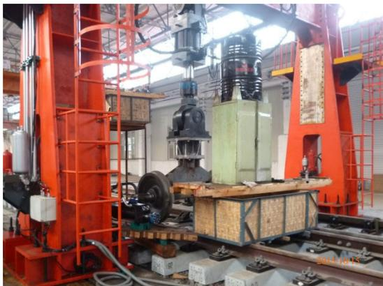
道岔動態測試設備
