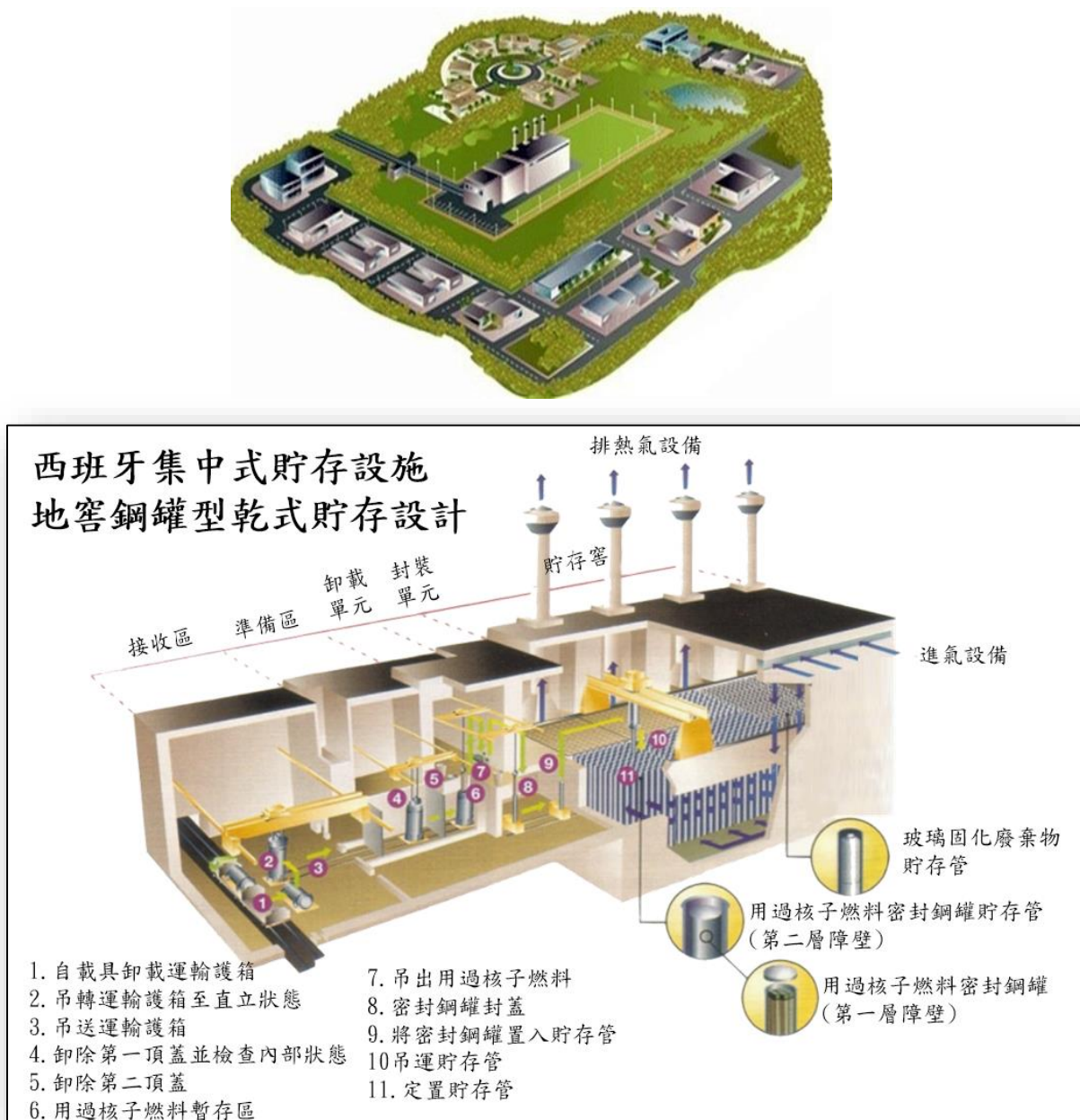
圖 4、西班牙 ENRESA 公司之用過核子燃料集中式貯存設施示意圖
